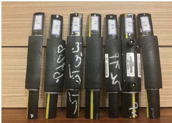
شکل ۱۰ نمونه برش طولی سرجوش‌ها برای آزمون لهیدگی
