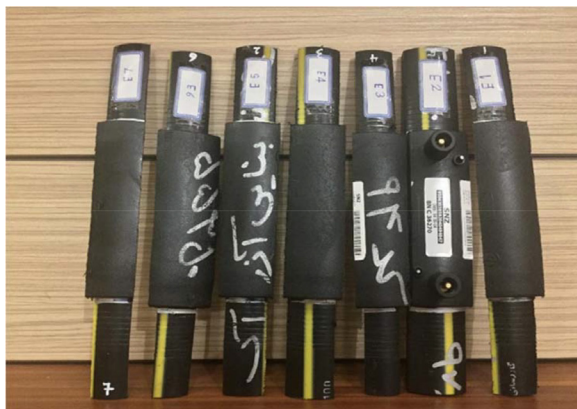
شکل ۱۰ نمونه برش طولی سرجوش‌ها برای آزمون لهیدگی
