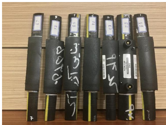
شکل ۱۰- نمونه برش طولی سرجوش ها برای آزمون لهیدگی
