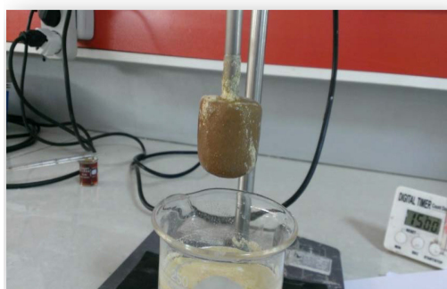
شکل ۸ پلاگ باقیمانده در آخر آزمایش (ROP-Enhancer 1%)
