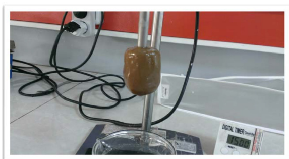
شکل ۳ گل باقیمانده روی شفت در آخر آزمایش استفاده از NaCl(SSW)
