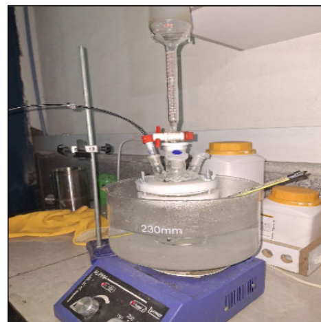
شکل ۴ سنتز پلیمر در فلاسک ۴ دهانه
