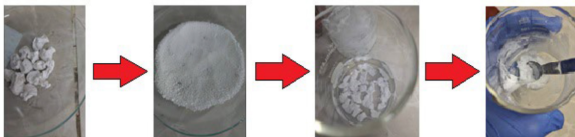
شکل ۱۰ مراحل استخراج آب و خشک کردن پلیمر
