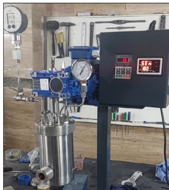
شکل ۵ سنتز پلیمر در رآکتور استیل L ۱
