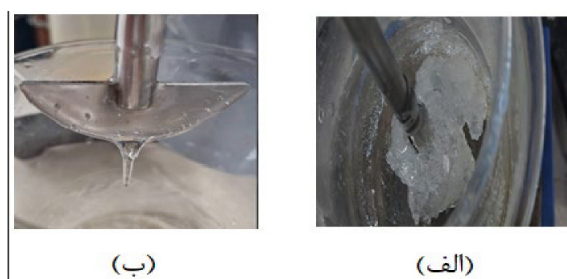
شکل ۷ محلول پلیمر سنتز شده با غلظت ۱۰٪ (الف: روش حرارتی، ب: روش اکسایش-کاهش)
