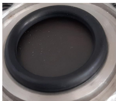
شکل ۲ غشای دیسکی کامپوزیتی در داخل یک مدول استیل ضد زنگ
