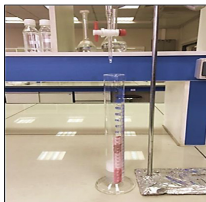
شکل ۳ شماتیک اندازه‌گیری پایداری فوم به روش راس-میلز. Fig. 3 Schematic of foam stability measurement using the Ross-Miles method.
