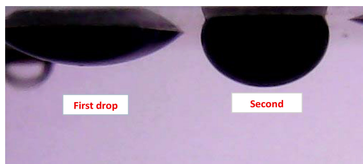
شکل ۱۴ مقایسه زاویه تماس قطره‌ی اول و دوم به ترتیب در حالت انتشار و همرفتی برای نانوسیال. Fig. 14 Comparison of contact angle of first drop and second drop based on diffusion and advection states for nano-fluid respectively.
