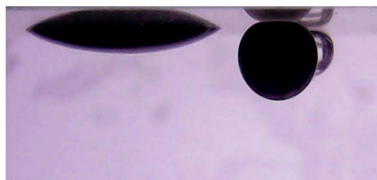
شکل ۲۰ مقایسه زاویه تماس قطره‌ی اول و دوم به ترتیب در حالت انتشار و همرفتی برای مخلوط سورفکتانت و نانوذره. Fig. 20 The comparison of the contact angle of first and second drops in the states of diffusion and advection for the mixture of surfactant and nano-particle.
