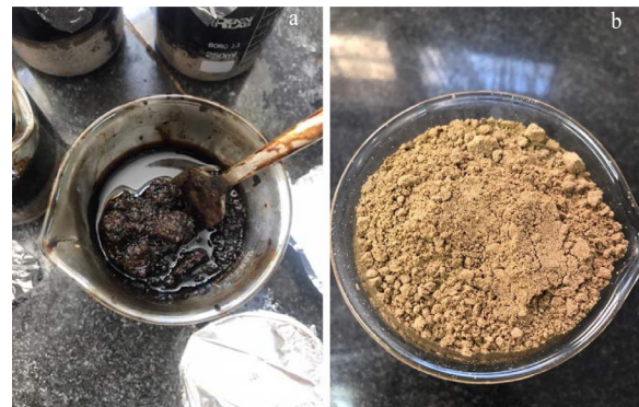
شکل ۳ الف: مخلوط نفت و پودر شیشه قبل از پیرسازی و ب: پودر شیشه پس از پیرسازی، شستشو و خشک شدن
