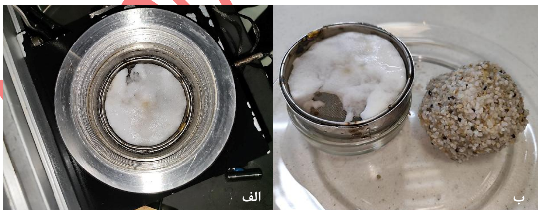
شکل ۹: الف) هیدرات تشکیل شده زیر درپوش راکتور ب) هیدرات تشکیل شده درون ماسه‌های سیلیسی
