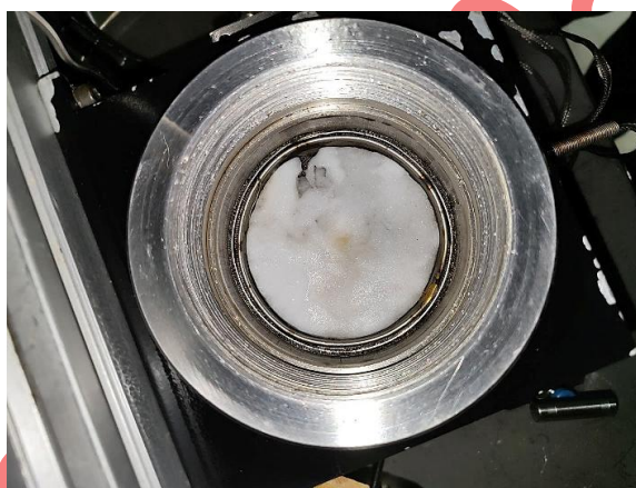
شکل ۹: تصویر هیدرات متان تشکیل شده درون بلورساز در یک نمونه آزمایش
