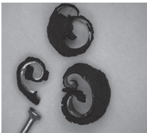
شکل ۹- نمونه‌هایی از پوسته‌های کربنی جدا شده از غشاء کربنی (بزرگ‌نمایی: ۲۵ X)
