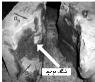
شکل ۹- گسترش شکافت هیدرولیکی در امتداد شکاف از پیش موجود (نمونه شماره ۵)
