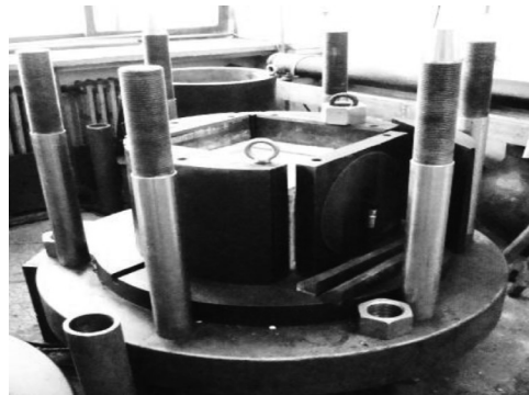
شکل ۱- سلول فشار سه محوره سیستم آزمایش شکافت هیدرولیکی
