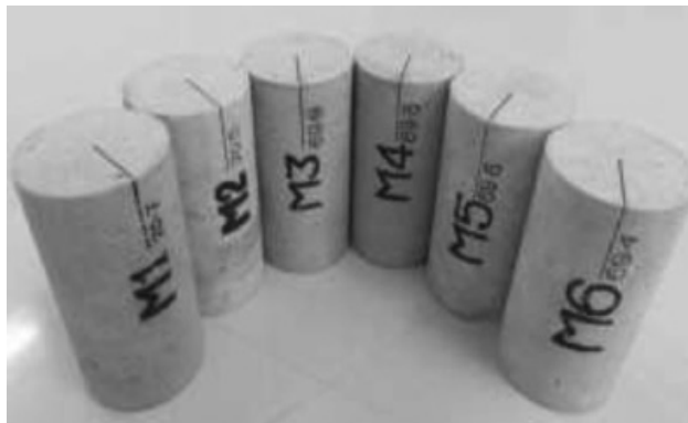
شکل ۱ نمونه مغزه‌های آماده‌شده و هم‌اندازه برای تزریق آب و نانوسیال [۲۴].
