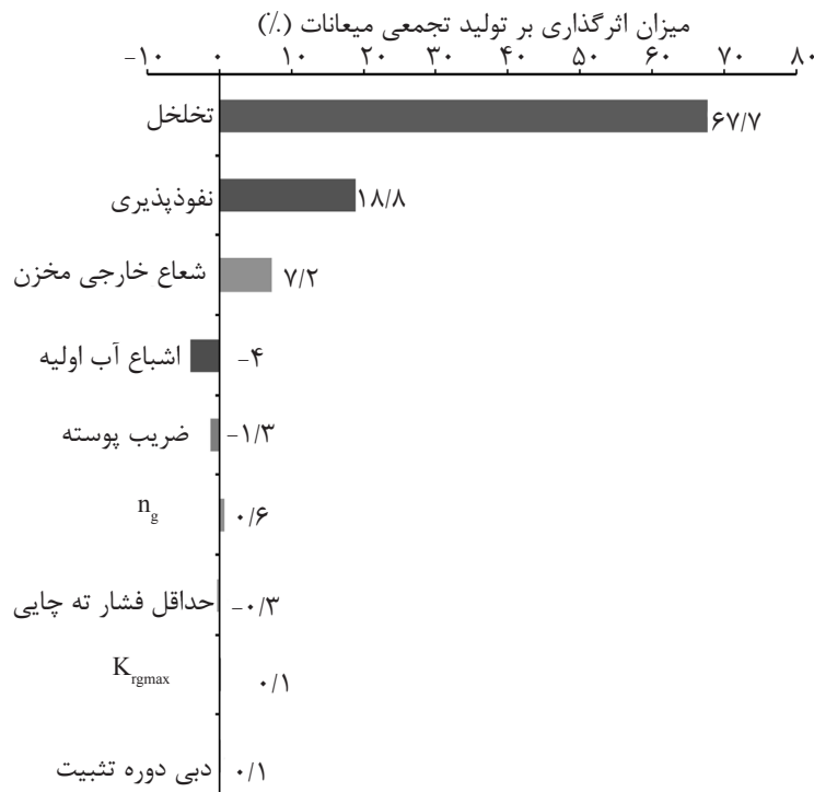
شکل ۴ نمودار تورنادو برای نشان دادن اثر عدم قطعیت در هر یک از داده‌های ورودی بر تولید میعانات تجمعی برای چاه عمودی.
