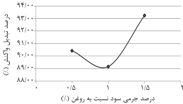
شکل ۱۰ تأثیر متوسط درصد جرمی سود نسبت به روغن بر درصد تبدیل واکنش.
