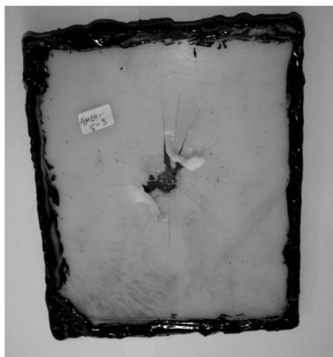
شکل ۵- نمونه پوشش Ma-g-PE به فولاد عمل آوری شده با محلول ۵٪، \gamma -APS پس از پایان آزمون جدایش کاتدی
