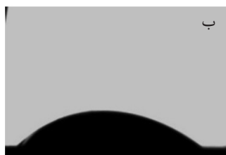
شکل ۳ الف) وضعیت ترشوندگی سنگ مخزن قبل از شبیه‌سازی شرایط مخزن (سنگ تمیز) ب)، وضعیت ترشوندگی بعد از شبیه‌سازی شرایط مخزن
