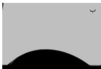
شکل ۳ الف) وضعیت ترشوندگی سنگ مخزن قبل از شبیه‌سازی شرایط مخزن (سنگ تمیز) ب)، وضعیت ترشوندگی بعد از شبیه‌سازی شرایط مخزن
