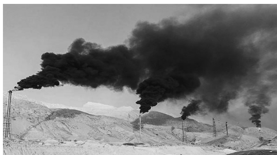
شکل ۱ شمائی از مشعل‌سوزی و کربن نسوخته منتشره از آن
