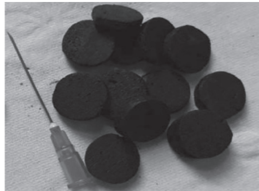
شکل ۲ آزمایش زاویه تماس بر روی قرص‌های سنگ برای تأیید نفت‌دوستی پس از مانس
