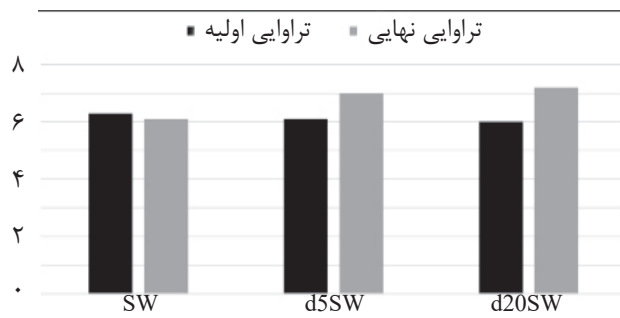
شکل ۸ تغییرات pH شورآب‌ها قبل و بعد از تزریق شدن به سنگ
