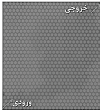
ب) فرایند تزریق پلیمر با غلظت ۱۵۰۰ ppm دبی تزریقی ۰/۱ PV/h برابر ۰/۰۰۶ mL/min
