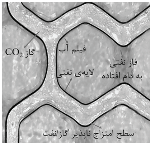
شکل ۶ حضور لایه‌ای از فاز نفتی بین فاز گاز و فیلم آب موجود بر دیواره
