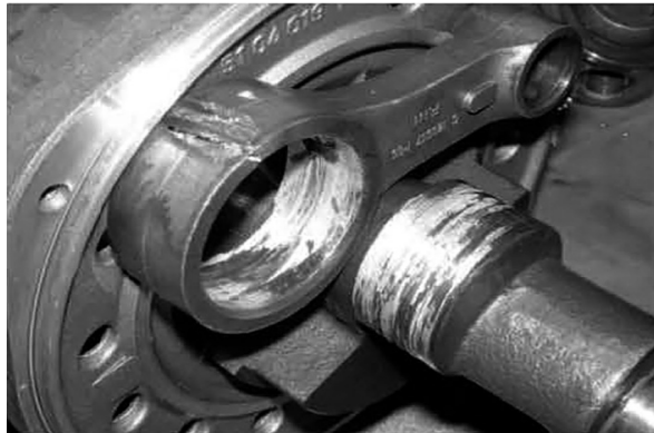
شکل ۶ جوش خوردن دسته پیستون به یاتاقان ژورنال میل لنگ بر اثر ایجاد فوم روغن
