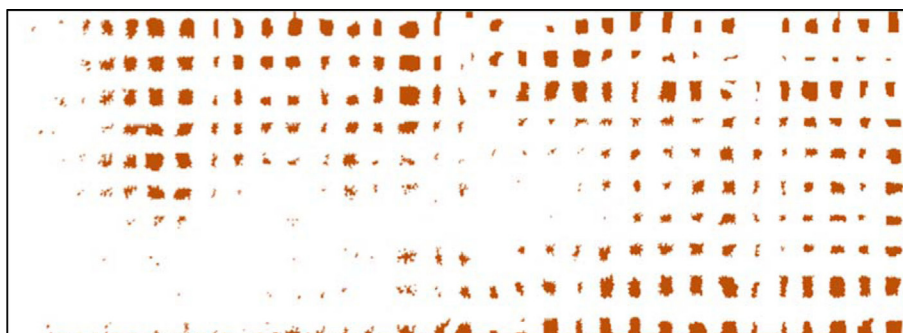
شکل ۸ خروجی مدل پالایش‌گریدی پس از ۱۰۰ هزار گام زمانی و تولید مسیر انحلال نزدیک به نتایج آزمایشگاهی
