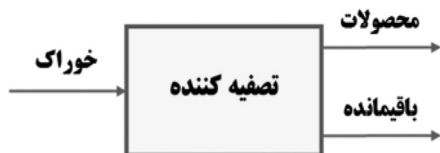
شکل ۴ واحد تصفیه هیدروژن، با یک چاه و دو چشمه
