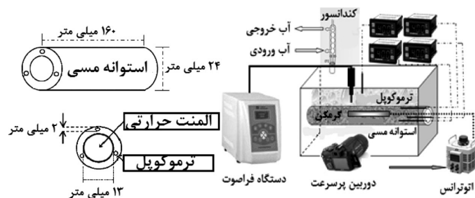
شکل ۱ الف) شماتیک دستگاه آزمایشگاهی و ب) المنت گرمایشی
