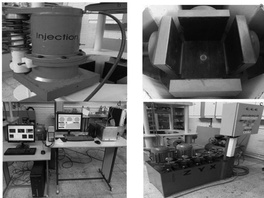
شکل ۳ (a) محفظه اعمال فشار، (b) واحد تزریق، (c) واحد هیدرولیک، (d) واحد جمع‌آوری و نظارت بر داده‌ها
