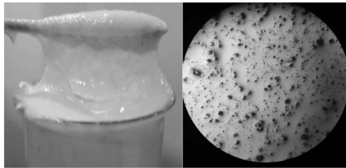
شکل ۲ الف تصویر میکروسکوپی ژل هیبریدی و ب) ژل هیبریدی در مرحله کراس لینکینگ
