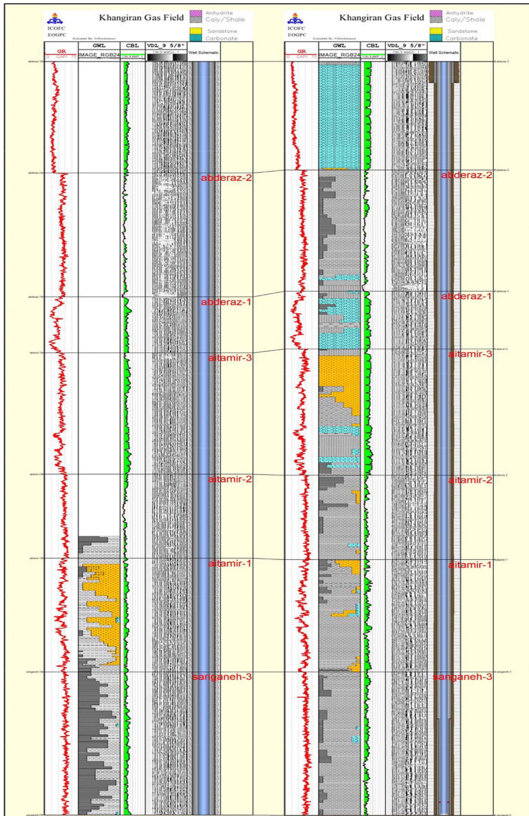
شکل ۵ تصویر کیفیت سیمان بندی دو چاه خانگیران مربوط به پشت لوله جداری ۹ ۵/۸"
