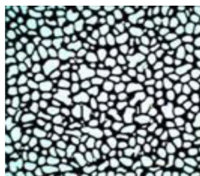
شکل ۱ نمای کلی میکرومدل شیشه‌ای شبه دو بعدی که براساس از تصویر سی تی اسکن مغزه به دست آمده است [۲۴]
