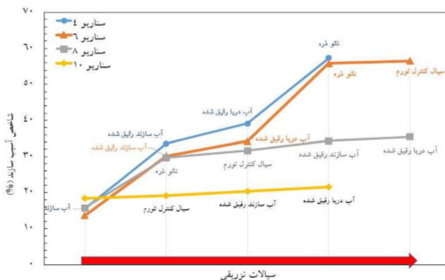
شکل ۱۹ مقایسه الگوهای تزریق در محیط متخلخل حاوی مخلوط ۱۰ wt.% کائولینیت و اسمکتیت
