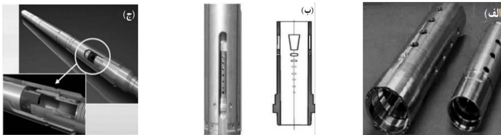
شکل ۱ الف) شیرهای درون‌چاهی چهار دریچه‌ای، ب) هشت دریچه‌ای و ج) دریچه پیوسته
