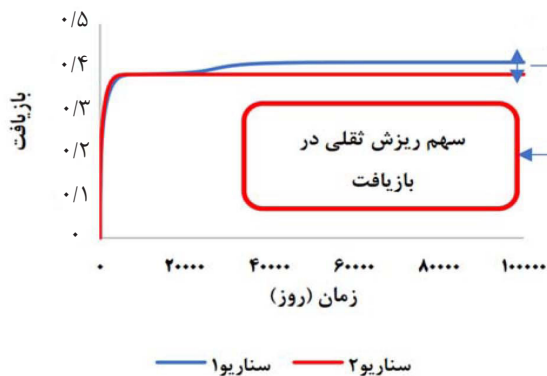
شکل ۱۰ الف: میزان بازیافت برنامه ی ۱ و ۲ و تعیین سهم ریزش ثقلی، ب: میزان بازیافت برنامه ی ۱ و ۳ و تعیین سهم آشام خودبخودی (نیروی موئینه مثبت)
