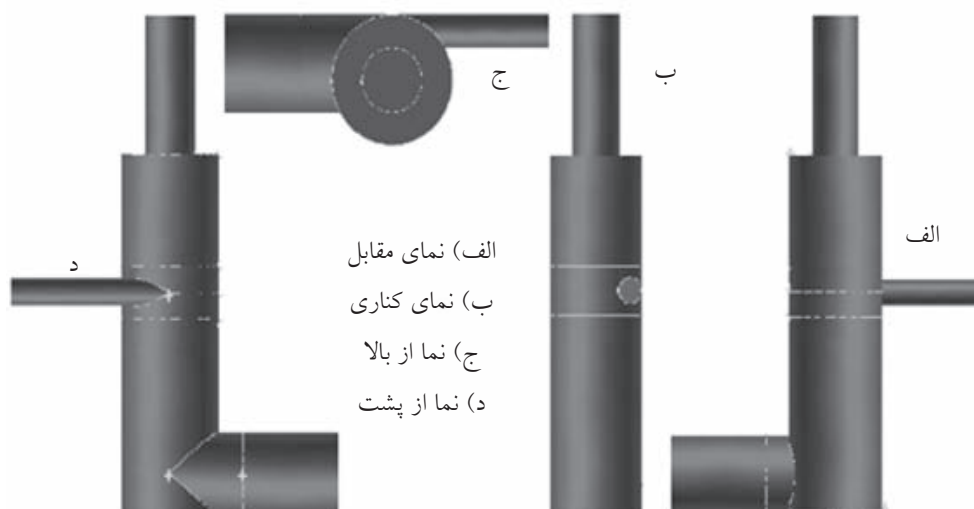
شکل ۲- چهار نمای متفاوت از جداکننده LLCC مورد شبیه‌سازی
