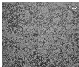
شکل ۵- عکس از میکرومدل (الف): مرحله نهایی سیلاب‌زنی با آب (ب): مرحله نهایی سیلاب‌زنی با محلول بیوسورفکتنت با غلظت 120\text{ mg/lit} در دبی 1\text{ ml/h}
