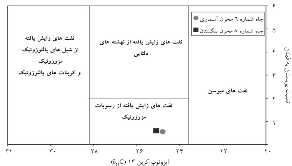
شکل ۱۱- نمودار (\delta^{13}C) در مقابل Pr/Ph برای نمونه‌های مخزن آسماری (چاه شماره ۶) و مخزن بنگستان (چاه شماره ۸).
