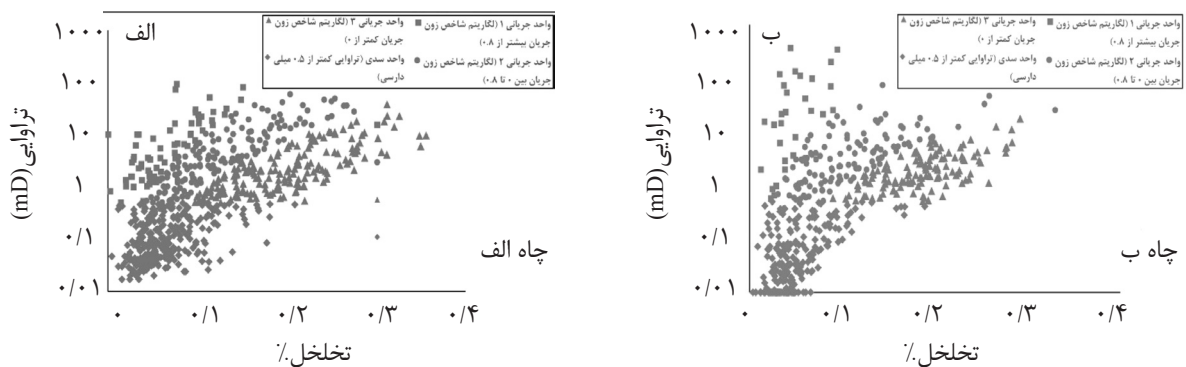
شکل ۴ پلات تخلخل در برابر تراوایی در واحدهای جریان شانسایی شده از طریق روش شاخص زون جریان برای دو چاه الف و ب. سه واحد جریانی همراه با یک واحد غیر مخزنی (با حد برش تراوایی کمتر از ۰/۱ mD) مشخص شده است.
