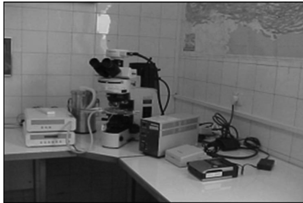
شکل ۲ دستگاه میکروسکوپ نوری مجهز به عدسی‌های با فاصله کاری طولانی.
