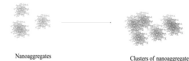
شکل ۲ ساختارهای احتمالی آسفالتین موجود در محلول آسفالتین-تولوئن.
