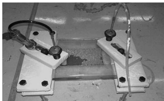
شکل ۲ میکرومدل، نگهدارنده و پورت‌های تزریق.
