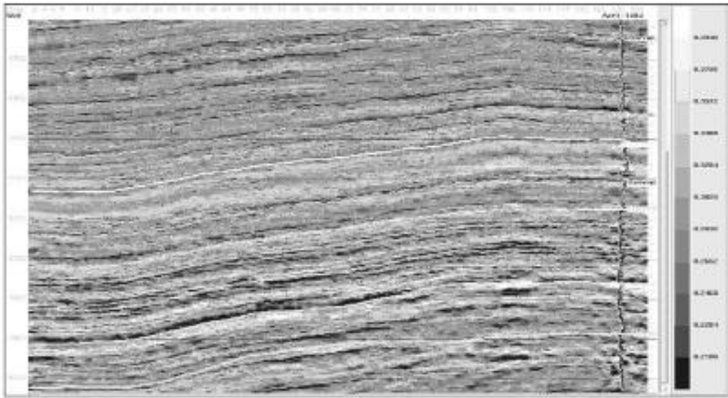
شکل ۳- نسبت ضریب پواسون در مقطع لرزه‌ای و پیش‌بینی تخلخل سازندهای مختلف به سمت رنگ سیاه: مخزن با تخلخل مناسب، به سمت رنگ سفید: مخزن با تخلخل ضعیف
