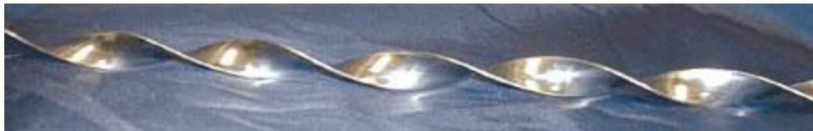
نمودار ۸- نمونه هایی از وسایل افزایش دهنده انتقال حرارت از نوع نوار تابیده (Twisted Tape)
