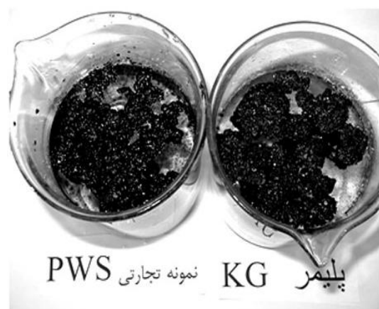
شکل ۲- در شرایط کاملاً مشابه عملکرد دو پلیمر انتخابی (SBS(KD) و SEBS(KG) نسبت به نمونه های تجاری بهتر است و شفافیت آب باقیمانده قابل ملاحظه می باشد.
